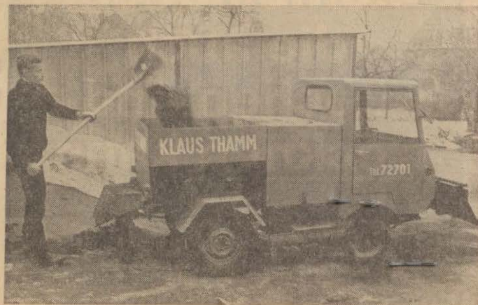
Nachschub herangeholt wird hier von den Spezialfahrzeugen der Firma Thamm. Trotz ihrer Spikes-Reifen hatten die kleinen Streuwagen oft große Mühe, auf den vereisten Bürgersteigen vorwärts zu kommen.
